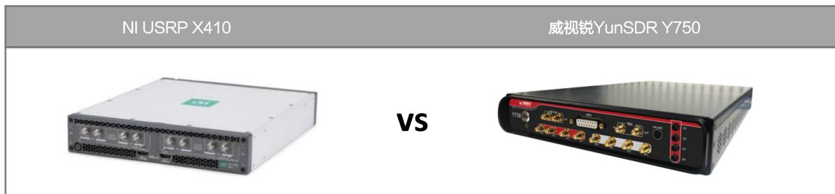
YunSDR Y750也是基于Xilinx Zynq UltraScale+ RFSoc构建，只是与X410的第一代RFSoc不同，Y750是基于第三代RFSoc构建，而且没有“锁频”，瞬时带宽可以达到2GHz，在商业SDR领域一骑绝尘，通道数量不仅支持四通道，还可以支持八通道（Y790）。
